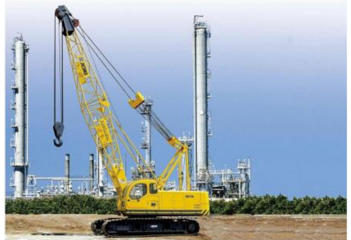
Guindaste sobre trator esteira com lança metálica treliçada
